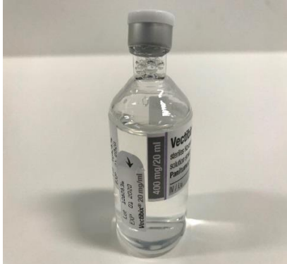
Bild 1: Injektionsflaska där gummipropp och snäpplock sitter snett
