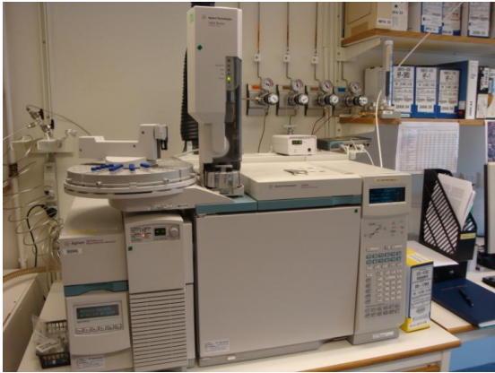
Figur3. Analyserna utfördes på en gaskromatograf (Hewlett Packard 6890N) med en masspektrometisk detektor (Hewlett Packard 5973 Network)
